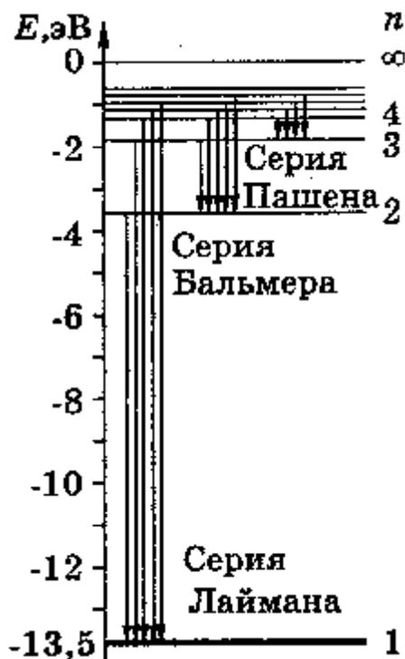
Рис.1.5. Схема энергетических уровней атома водорода
